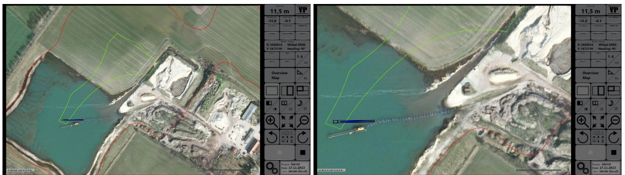
Lagepläne mit unterlegtem Luftbild, maßstabsgerechtem Saugrohr-Bagger und Abbaugrenzen
